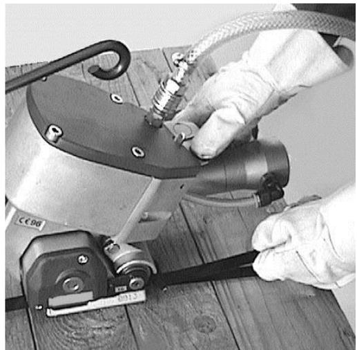
6. Saisir de la main gauche l'extrémité du feillard sectionné, presser de la main droite le levier d'air **(c)** et le moteur à air comprimé **(f)** avant de basculer l'appareil vers la droite pour le sortir du cerclage.
