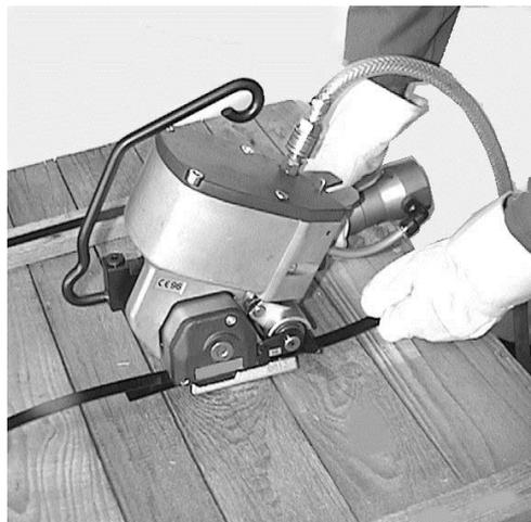
4. Mit der rechten Hand den Taster "Band spannen" (a) drücken bis er in die Raste (g) einrastet (Löst man die Taste, bleibt der Druckluftmotor stehen). Bei PKE-Geräten mit eingebautem Freilauf ist der Taster "Band spannen" (a) so lange gedrückt zu halten, bis die gewünschte Bandspannung erreicht ist.
