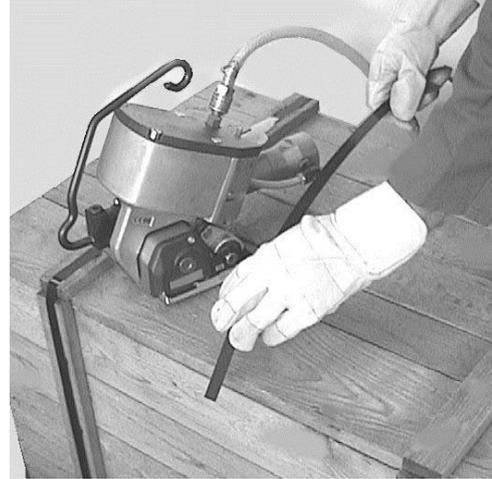
2. Tirer l'extrémité du feillard jusqu'à ce qu'il se trouve au milieu de la pièce à emballer en dessous du feillard supérieur, tout en dépassant d'une longueur d'une main.
