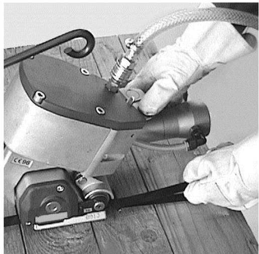
6. Das abgeschnittene Bandende in die linke Hand nehmen, den Lufthebel (c) und den Druckluftmotor (f) mit der rechten Hand zusammendrücken und das Gerät nach rechts aus der Umreifung schwenken.
