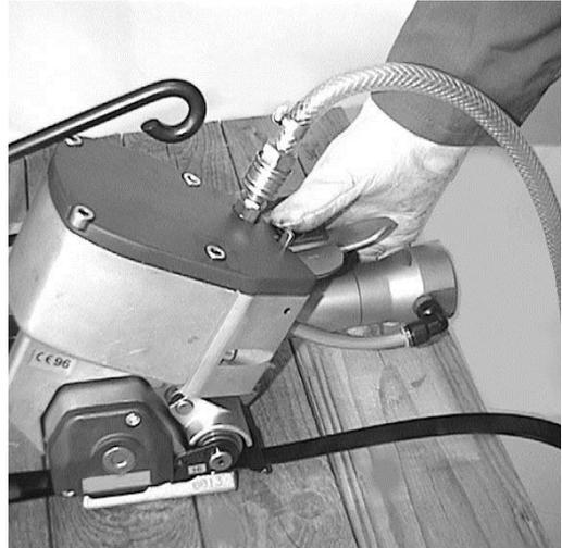
5. Lorsque la tension nécessaire du feillard est atteinte, on appuie sur la touche „fermeture“ **(b)** jusqu'à ce que la fermeture soit effective et que l'on entende clairement le découpage du feillard d'emballage derrière la fermeture.
