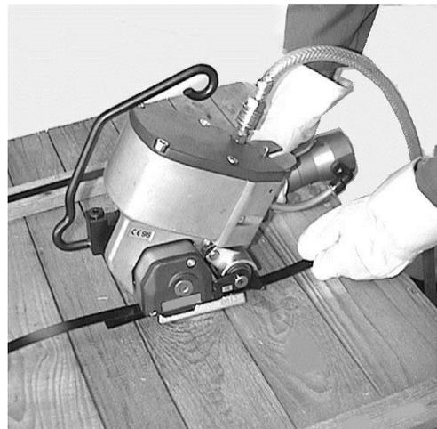
4. Appuyer de la main droite sur la touche "tendre le feillard" **(a)** jusqu'à ce qu'il soit bloqué **(g)** en débloquant le dispositif, le moteur à air comprimé s'arrête). Sur les **appareils PKE** doté d'une roue libre intégrée, il est nécessaire de maintenir enfoncé la touche "tendre le feillard" **(a)** jusqu'à ce que la tension souhaitée du feillard soit atteinte.
