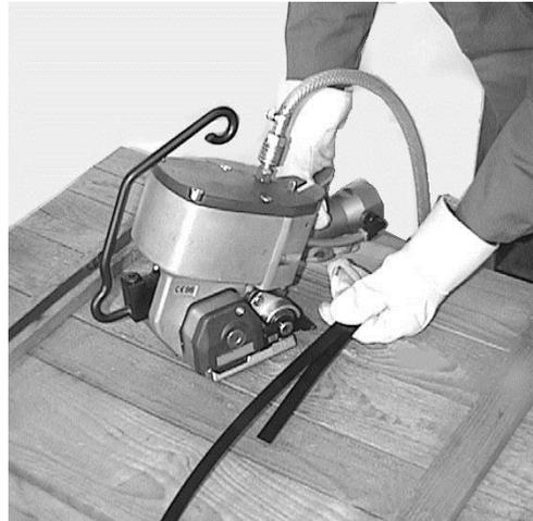
3. Mit der linken Hand beide exakt übereinanderliegenden Bänder festhalten. Lufthebel (c) und Druckluftmotor (f) mit der rechten Hand umfassen und zusammen drücken. Beide Bänder bis zum Anschlag an der Gehäusewand seitlich in das Gerät schieben. Dabei muss das untere Band vorne etwas aus dem Gerät herausragen. Die zusammengedrückten Hebel (c) und Motor (f) loslassen.
