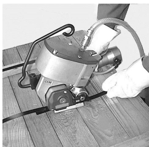
4. Appuyer de la main droite sur la touche "tendre le feuillard" (a) jusqu'à ce qu'il soit bloqué (g) en débloquant le dispositif, le moteur à air comprimé s'arrête). Sur les **appareils PKE-HD** doté d'une roue libre intégrée, il est nécessaire de maintenir enfoncé la touche "tendre le feuillard" (a) jusqu'à ce que la tension souhaitée du feuillard soit atteinte.
