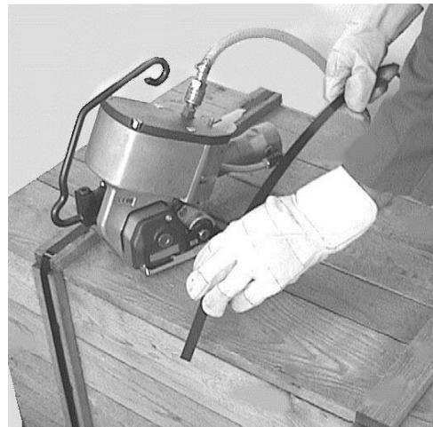
2. Tirer l'extrémité du feuillard jusqu'à ce qu'il se trouve au milieu de la pièce à emballer en dessous du feuillard supérieur, tout en dépassant d'une longueur d'une main.
