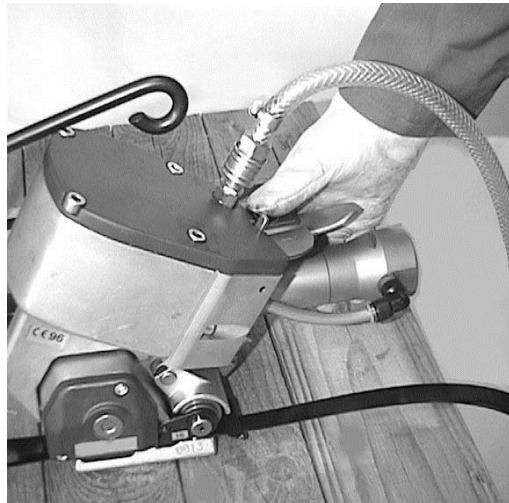
5. Ist die erforderliche Bandspannung erreicht, drückt man den Taster "Verschluss" (b) so lange bis der Verschluss gebildet ist und das Verpackungsband hörbar hinter dem Verschluss abgekerbt ist.
