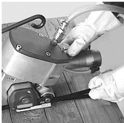
6. Das abgeschnittene Bandende in die linke Hand nehmen, den Lüfthebel (c) und den Druckluftmotor (f) mit der rechten Hand zusammendrücken und das Gerät nach rechts aus der Umreifung schwenken.
