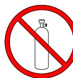
N'utiliser pas de bouteilles à gaz ou des bouteilles à air comprimé! L'appareil ne doit être jamais raccordé à une bouteille à gaz ou à air comprimé.
