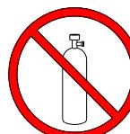
Keine Gas- oder Druckluftflaschen verwenden! Das Gerät darf nicht an eine Gas- oder Druckluftflasche angeschlossen werden.
