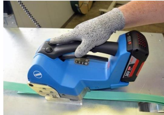
**Ziehen Sie Hebel 3 zum Griff und halten sie ihn fest. Das Band ist nun freigegeben. Das Gerät bei gehaltenem Hebel nach rechts aus der Umreifung schwenken.**
