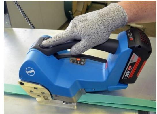
**Ziehen Sie Hebel 3 zum Griff und halten sie ihn fest. Das Band ist nun freigegeben. Das Gerät bei gehaltenem Hebel nach rechts aus der Umreifung schwenken.**
