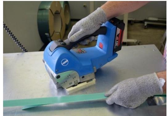
**Beide Bänder bis zum Anschlag an der Gehäusewand seitlich in das Gerät ziehen.**
