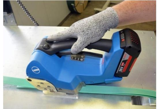
**Pour la soudure, appuyer sur le bouton-poussoir 2, la phase de soudure est enclenché.**
