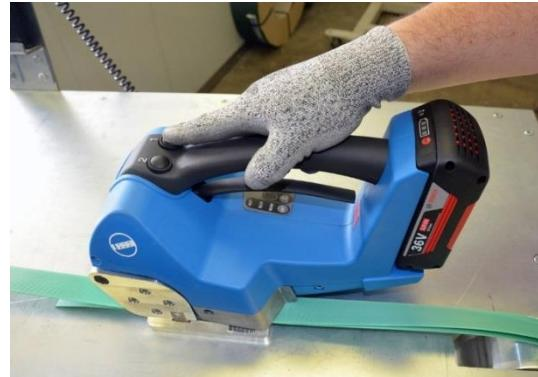
Actionner le levier 3, le feuillard plastique est libéré, maintenir le levier 3 et retirer l'appareil vers la droite.
