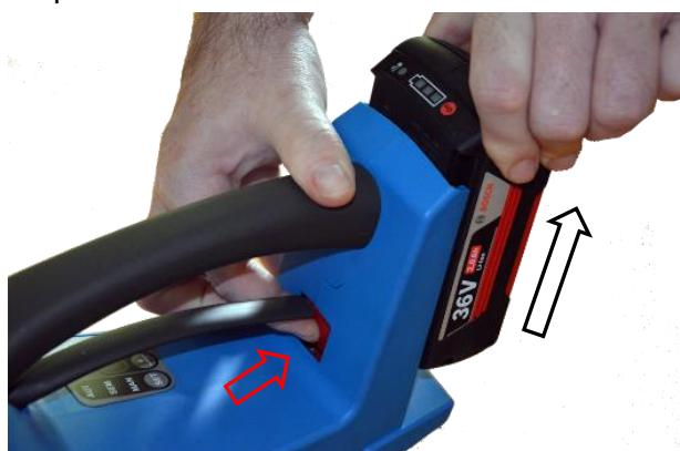
Pour le changement de la batterie Li-Ion (130), appuyer sur le déverrouillage (121) et tiré la batterie Li-Ion vers le haut.
