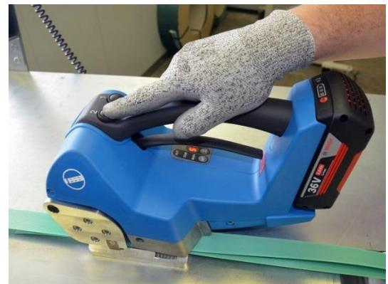
**Actionner le levier 3, le feuillard plastique est libéré, maintenir le levier 3 et retirer l'appareil vers la droite.**
