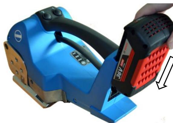
Ensuite, enficher de nouveau la batterie Li-Ion (130) jusqu'à la butée à l'emplacement prévu à cet effet.
